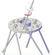
Eindrehen der Stäbe 7-12 in die Gewinde zuvor 2-3 Umdrehungen von Hand einschrauben.
