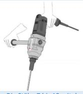
9. Die Stäbe 7 bis 12 mit dem Ein-/Ausdrehwerkzeug Eilgang so weit wie möglich eindrehen.
