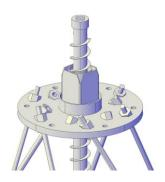
6. Die Stäbe 1 bis 6 mit dem Ein-/Ausdrehwerkzeug Kraftgang vollständig eindrehen.
