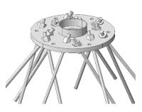
10. Die Stäbe 7 bis 12 mit dem Ein-/Ausdrehwerkzeug Kraftgang vollständig eindrehen.
