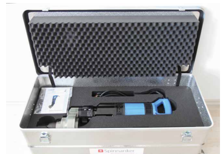
Ankerstäbe (oben) und das zugehörige Eindrehwerkzeug (rechts)
