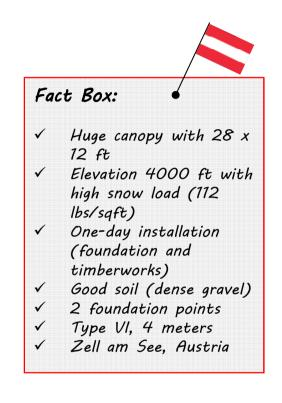
Spinnanker Betonlose Fundamenttechnik
